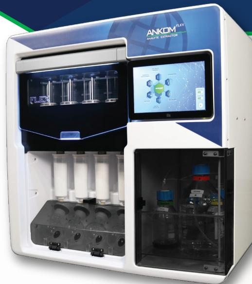
ANKOM<sup>FLEX</sup> 分析抽出器は脂溶性ビタミン、コレステロール、粗脂肪、加水分解脂肪の測定を簡略化するために設計されています。一度に最大4つのサンプルに対応し、約2~3時間で消化、固相抽出(SPE)、蒸発が自動的に完了します。
