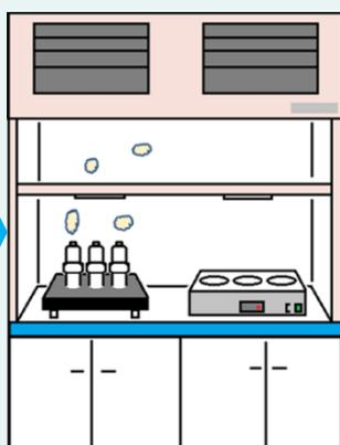
加熱開始 試薬が気化 気化がピーク 試薬が還流 この工程を繰り返す
