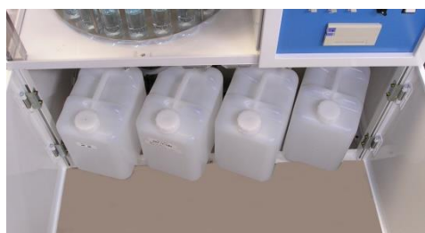
試薬タンク（ホウ酸吸収液・アルカリ・蒸溜水・廃液）は全てサンプラー下部に収納
