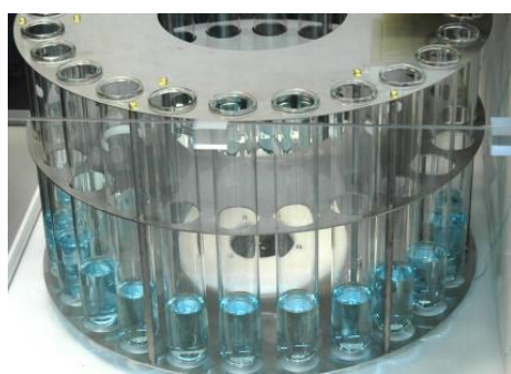
ケルダールチューブは、専用ラックに24本収納可能
