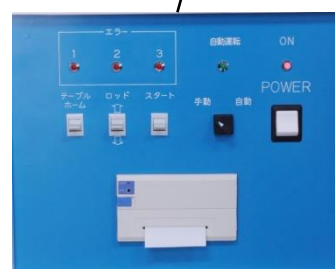
プリンターを内蔵した、シンプルな操作パネル
