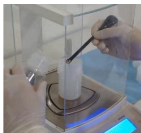
分解容器を天秤に のせてサンプリング
